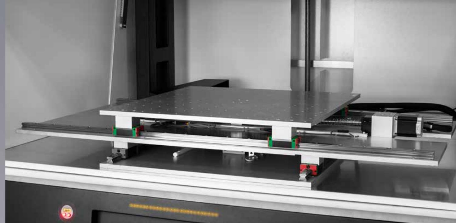
Durch die Möglichkeit bis zu vier Achsen zu steuern, eignet sich die EMS 400 optimal für sehr große Beschriftungsflächen oder Serienvorrichtungen. Durch programmierbare X-, Y- und Z-Achsen können sehr große Beschriftungen gemacht werden oder mehrere Bauteile innerhalb einer Vorrichtung automatisch beschriftet werden. Die automatische Türe bietet maximalen Bedienerkomfort.
