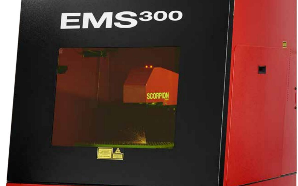
Ein großer Arbeitsbereich und entfernbare Seitenwände machen die EMS 300-Arbeitsstation äußerst flexibel. Die pneumatische Türe bietet maximalen Bedienerkomfort für hohe Stückzahlen. Durch einen Permanentspeicher können sogar mehrere Programme am Handbedienteil aufgerufen werden, ohne einen PC zu verwenden. Die EMS 300-Arbeitsstation kann mit unterschiedlichen Scorpion- und Scorpion-Rapide-Faserlasermodellen ausgestattet werden.
